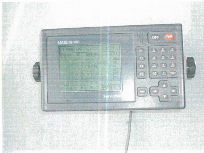
4.- Equipo de Protección AIS: Sistema de Identificación Automática.
