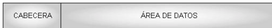
Figura 2.13 Forma general de los datagramas IP, con una cabecera seguida de datos. La cabecera tiene información que controla cuándo y dónde se envía el datagrama.
