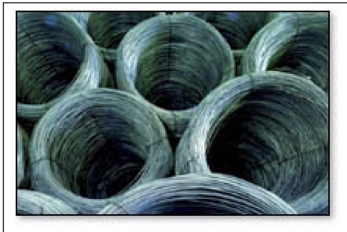
FIGURA 3.5 Foto de alambros usado como materia prima en el proceso de fabricación de clavos negros
