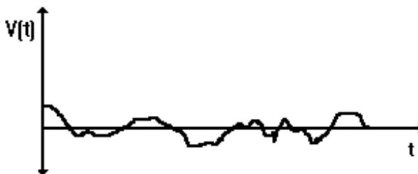
Figura 4.5 Ejemplo de ruido en una señal de voltaje
