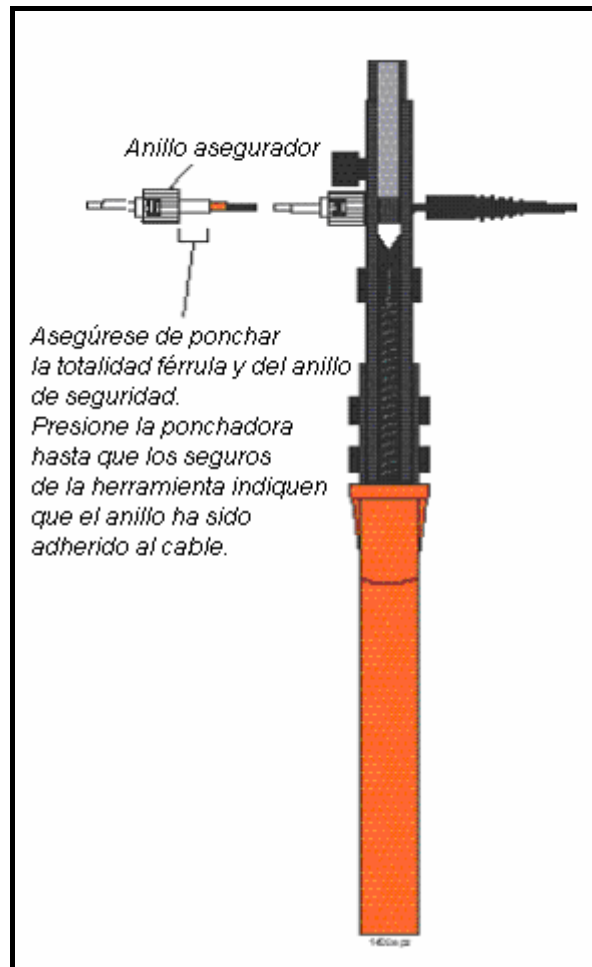
Figura 10.5. Posición correcta del conector ST en la ponchadora.
