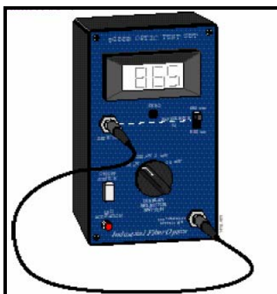
Figura 10.6. Medidor de potencia óptica.
