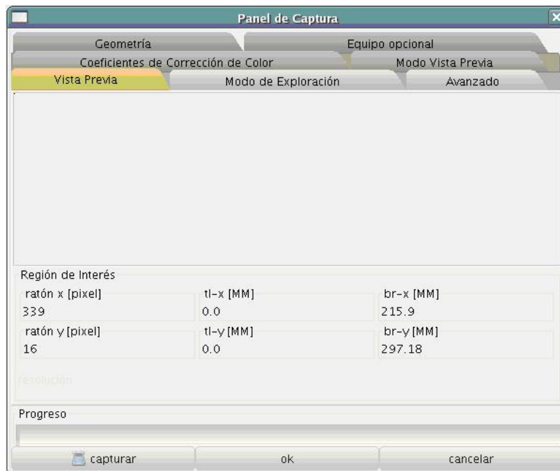
Figura 3.5. Cuadro de diálogo para realizar captura de imagen usando la interfaz SANE en Linux
