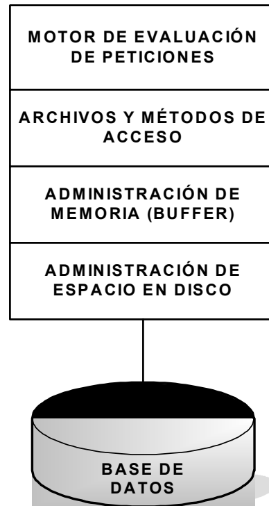
Figura 1.1 - Arquitectura básica de un DBMS – Modelo de capas [3]
