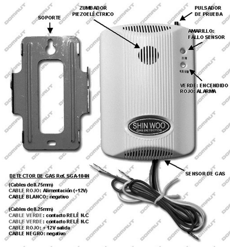
Figura 4.73. Detector de Fuga de Gas Shin Woo.
