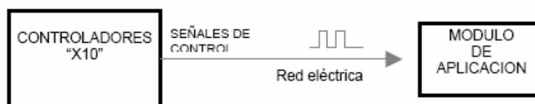
**Figura 1.1. Funcionamiento del Controlador**
