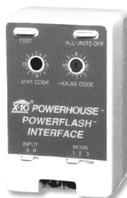
**Figura 4.68. Módulo Transmisor Powerflash.**
