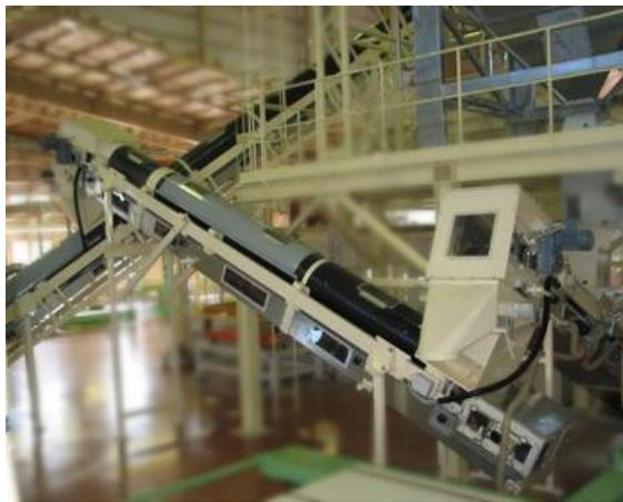
**FIGURA 2.12. Banda transportadora de cinta.**
