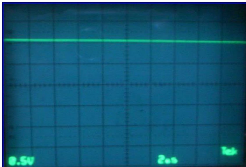
Foto 2.- Voltaje de Salida de 12 V, con carga
