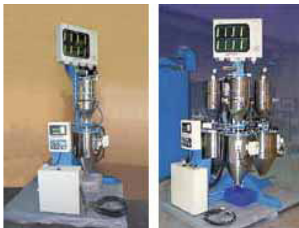
Figura 1.3 Dispensador de polvos para una y cuatro unidades respectivamente.
