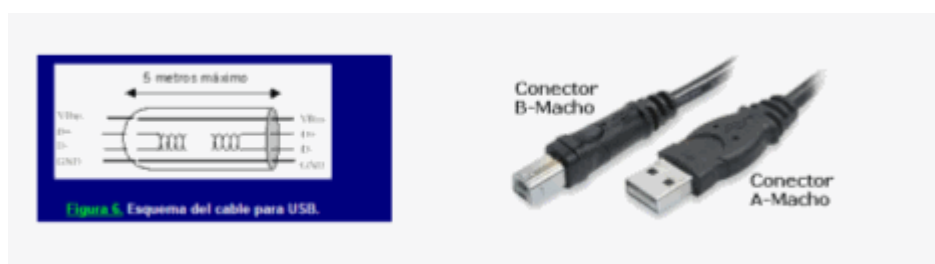
Figura 28.- Esquema del cable para la comunicación USB
