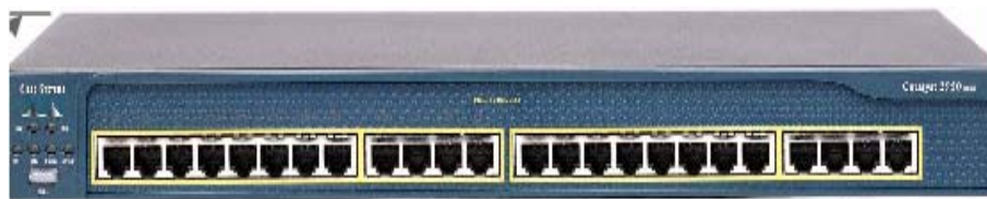
FIGURA 3.102 VISTA FRONTAL DEL SWITCH CISCO 2950
