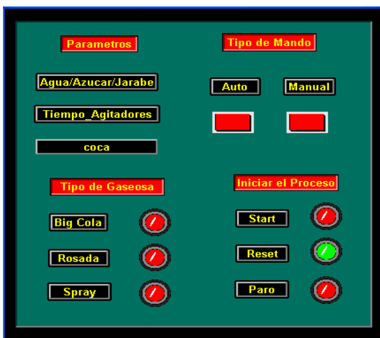
Figura 2.11 Ventana para la ejecución del proceso.
