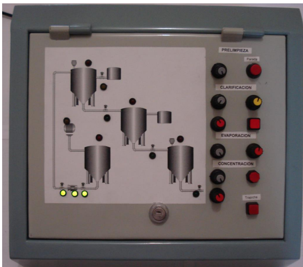
Figura 33. Vista frontal del tablero de simulación
