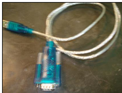
Figura.3.6-Foto real convertidor USB a Serial
