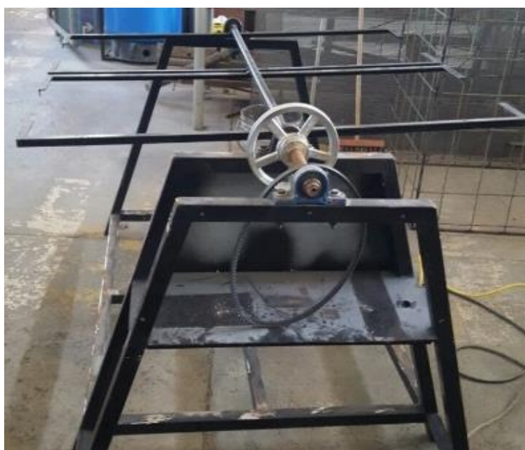
Figura 3.25: Polea y banda de la estructura metálica
