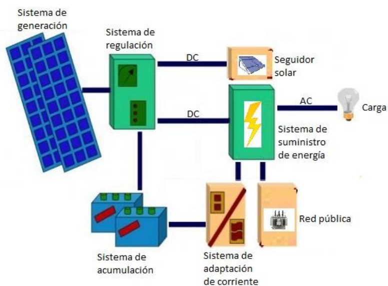
Figura 2.4: Diagrama de bloques del sistema fotovoltaico [6]
