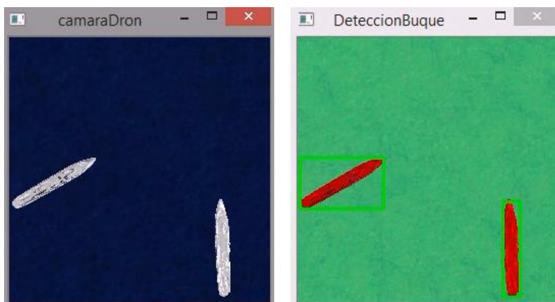
Figura 3.3: Cámara del Dron y Detección de los Buques
