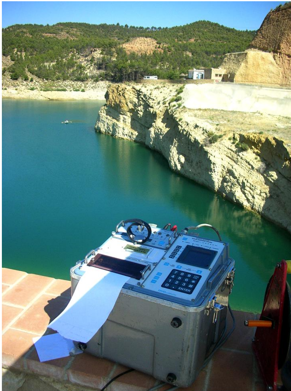
Figura 4.12 Detalle del equipo de testificación para medidas subacuáticas de potencial espontáneo
