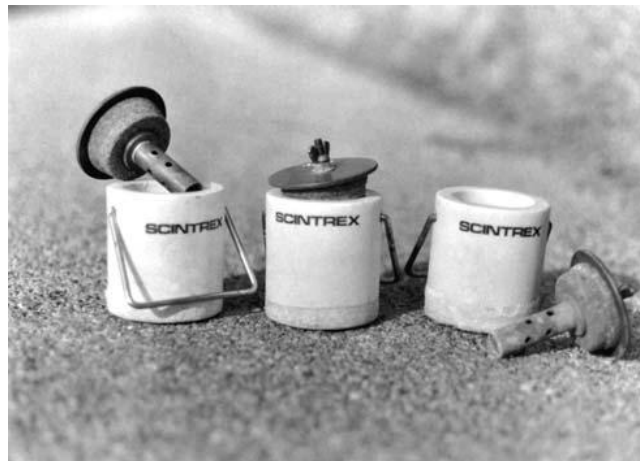
Figura 4.8: Electrodos no polarizables de sulfato de cobre
