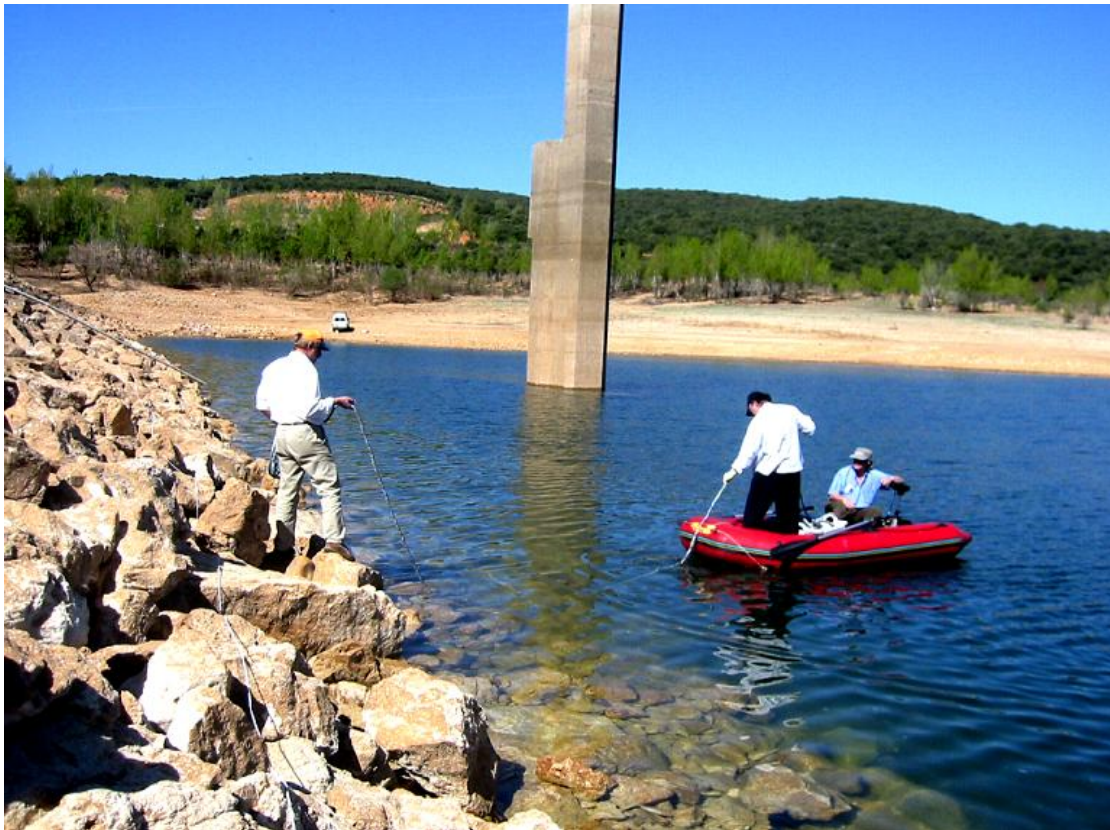
Figura 4.10: Bote, para llevar el cable con los electrodos desde la orilla hasta una distancia deseada dentro del embalse
