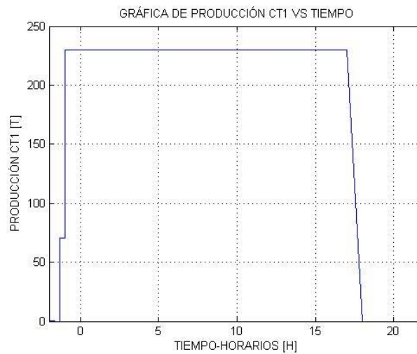
Figura 0. 29 Curva de producción vs. Tiempo de operatividad de equipo Eq31 producción de 9,000 toneladas de cemento sin equipos fuera de servicio
