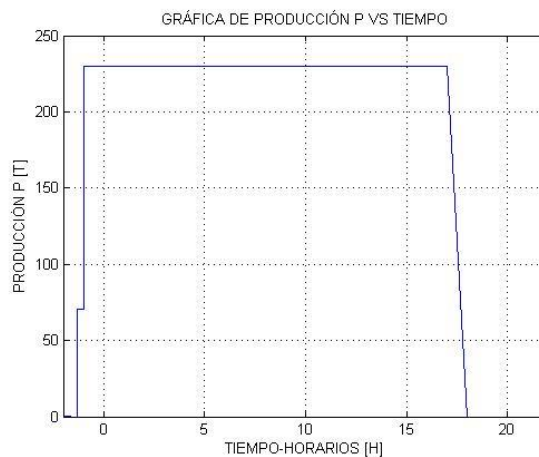
Figura 3.1 Curva de producción vs. Tiempo para 9000 toneladas de producción.
