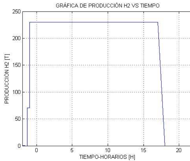
Figura 0. 27 Curva de producción vs. Tiempo de operatividad de equipo Eq22 producción de 9,000 toneladas de cemento sin equipos fuera de servicio
