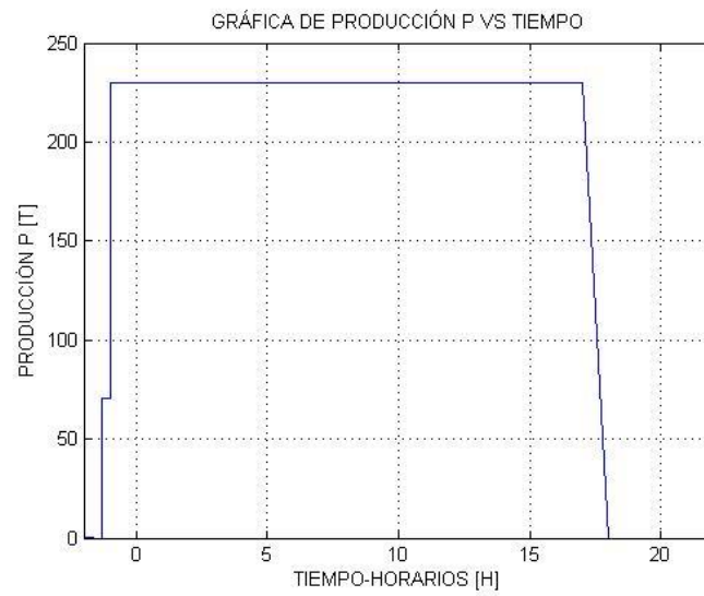
Figura 0. 32 Curva de producción vs. Tiempo de operatividad de equipo Eq00 producción de 9,000 toneladas de cemento sin equipos fuera de servicio
