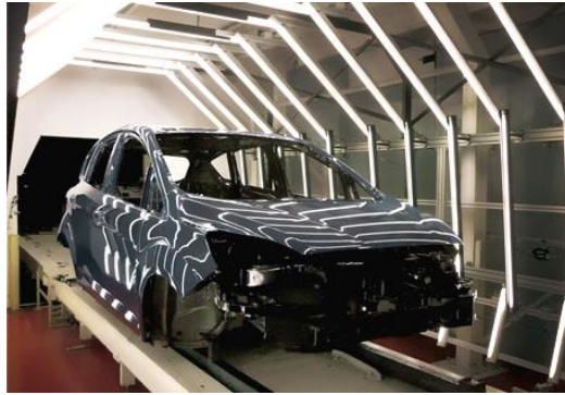
Figura 2.2 Cámara de chequeo de calidad de pintura en carrocería Ford
