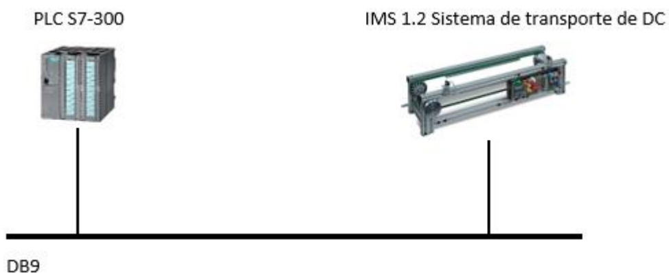
Figura 3.13 Diagrama de Conexión DB9 del Sistema
