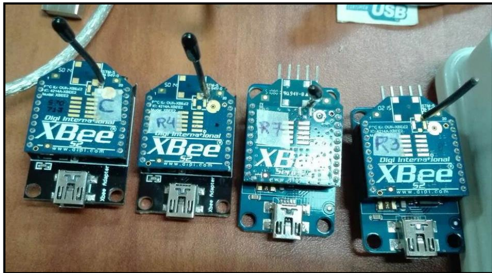
Figura 2.9 Módulos XBee Serie 2 Fuente: J. Pablo, X. Merino, 2017.
