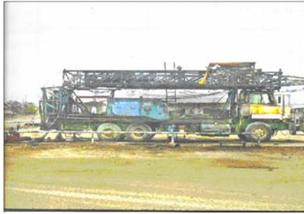
Figura 2.- Unidad de servicio bombeo para Swab.
