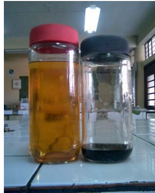
Figura 4.5 Biodiesel decantado y glicerol
