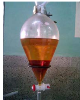
Figura 4.4 Decantación del Biodiesel
