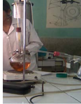
Figura 4.6 Destilación del Biodiesel
