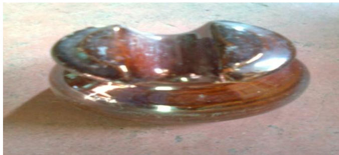
Figura 43: Aislado tipo Pin 55-5.
