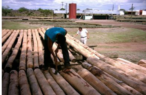
Figura 80: Vista de postes de madera descortizandolo y preparandolo para su mayor duracion tomado de catálogo de Altensa.s.a.
