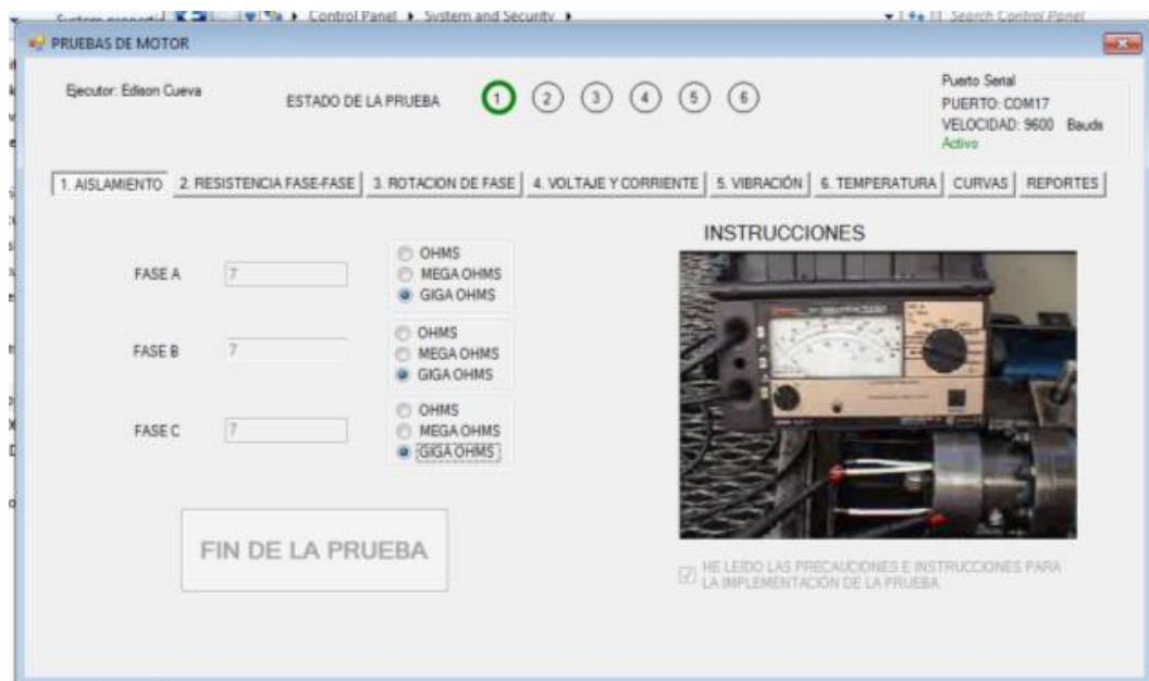
Figura 3. 11 Prueba de aislamiento
