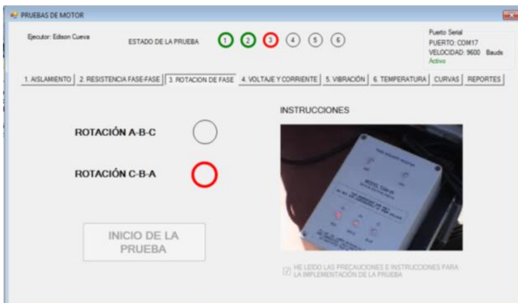
Figura 3. 25 Falla en la prueba de rotación de fase.
