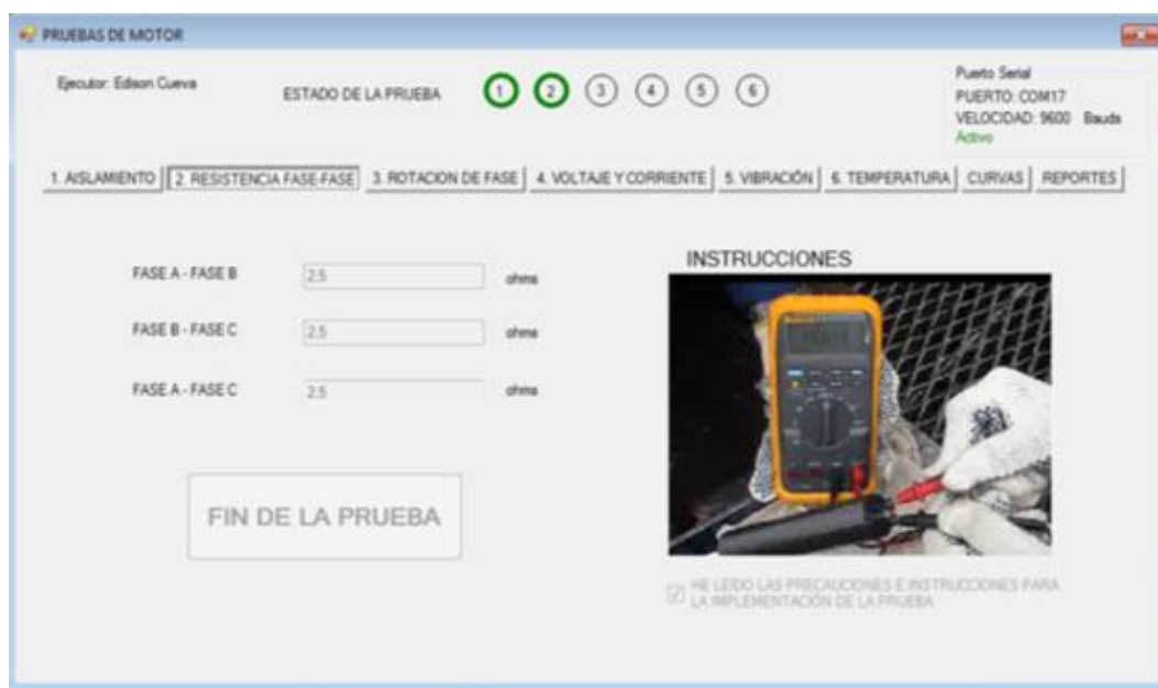
Figura 3. 14 Pantalla de interfaz usuario para pruebas de resistencia
