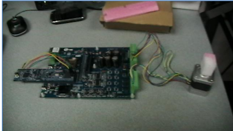
Figura 4.5: Módulo de control de motores NXP y motor BLDC
