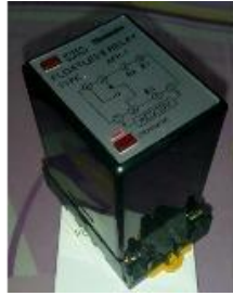
Figura 1.11 Controlador de nivel Camsco [Calser 2018]
