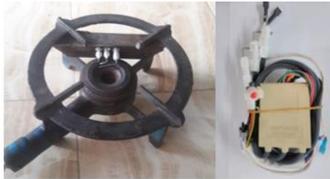
Figura 3.5 Base de electrodos y módulo electrónico
