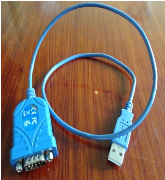
a) Cable USB Serial para PC
