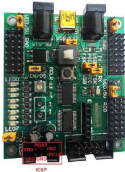
FIGURA 1.44: CONECTOR ICSP DEL MÓDULO MEI&T04
