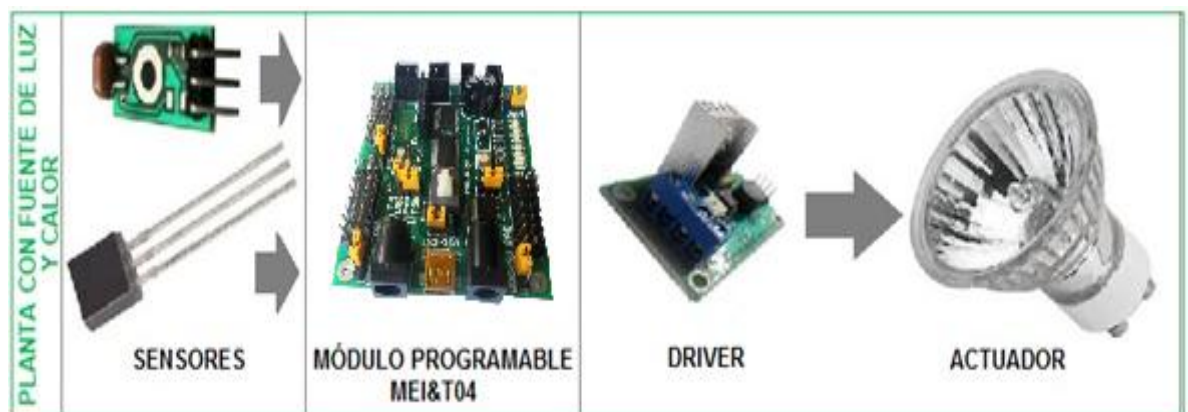
FIGURA 3.2: COMPONENTES DE LA PLANTA CON FUENTE DE LUZ Y CALOR
