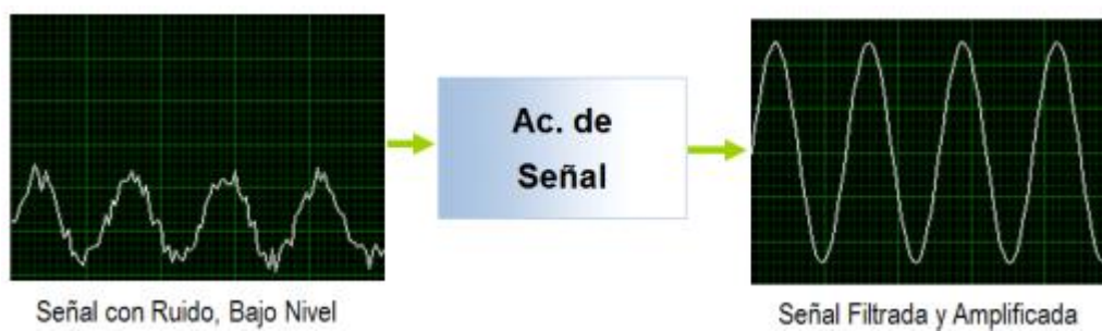
FIGURA 1.5: ACONDICIONADOR DE SEÑAL
