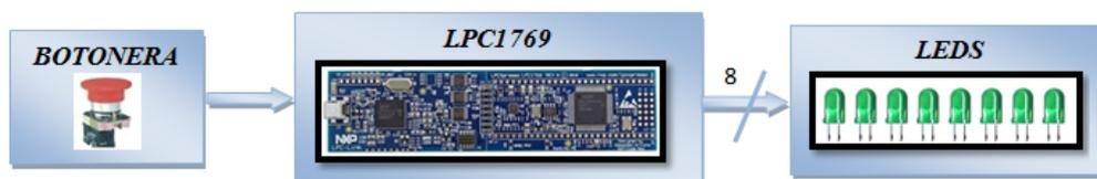
Figura 3.3.: Bloques de Secuencia de Leds.
