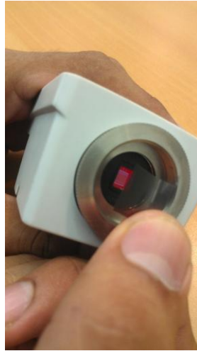
Figura 4.9 Proceso de Cambio de filtro infrarrojo por filtro de luz visible.
