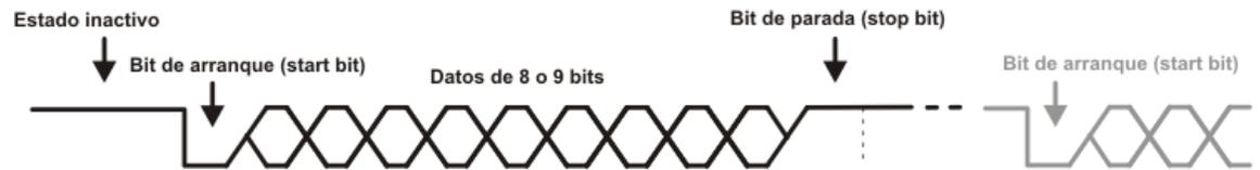
**Figura 2.19 - MÉTODO DE TRANSMISIÓN SERIAL [18]**
