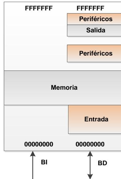
**Figura 2.11 - CONEXIÓN ENTRE PERIFÉRICOS [10]**
