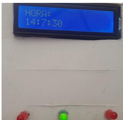
Figura 4.7: Adquisición de datos de hora a través del módulo GPS.
