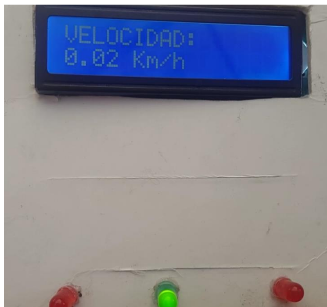
Figura 4.5: Adquisición de datos de velocidad a través del módulo GPS.
