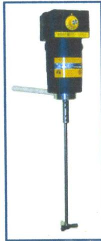
Figura 28. Agitador eléctrico – Modelo 1750.
