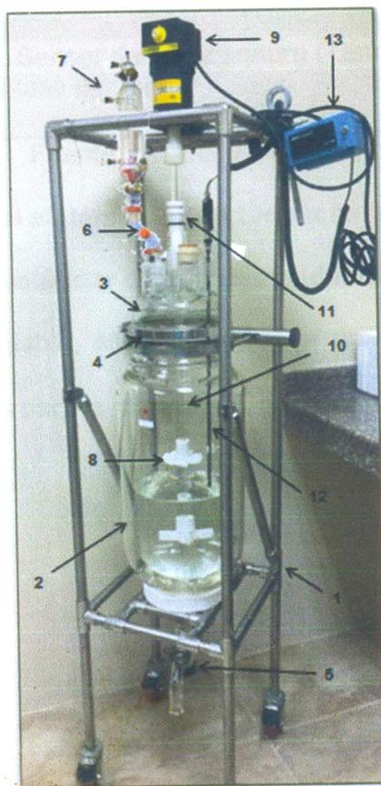
Figura 15. Sistema de Reactor encamisado de 20L
