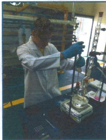
**Ilustración 2.** Toma de muestra de la reacción de esterificación del reactor de 2L.
