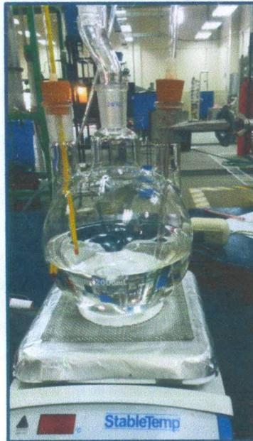
**Ilustración 1.** Sistema de reactor de laboratorio de 2L.
