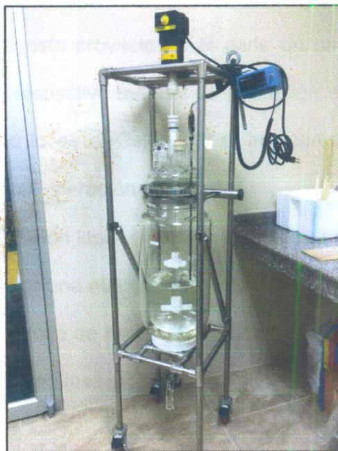
**Figura 1.** Reactor Batch marca ACE GLASS (68617) en LOPU
