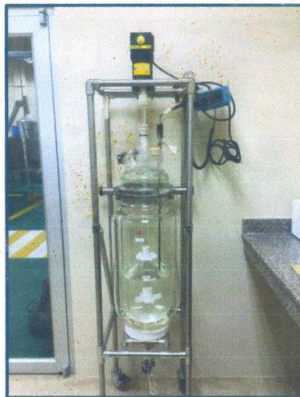
**Ilustración 4.** Reactor Batch en estado de almacenamiento.
