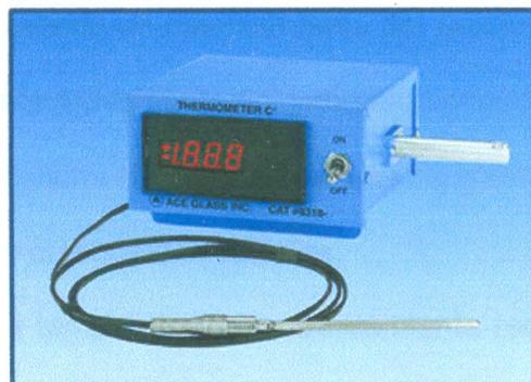
Figura 35. Pantalla termómetro digital.
