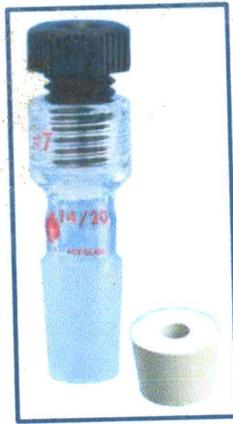
Figura 33. Ace Rosca Adaptador – Para sensor de temperatura.
