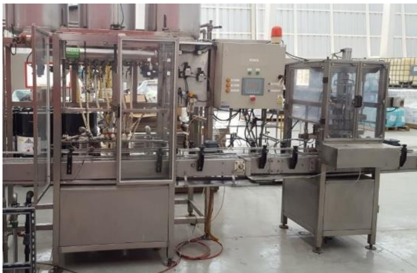
Figura 35 Llenadora LEL-6 posterior a los trabajos de implementación
