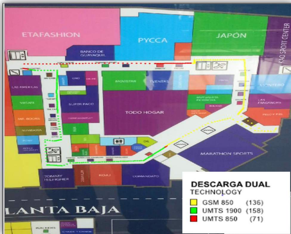
Figura 29 Walk test del piso 1 del centro comercial, muestras por tecnología.
