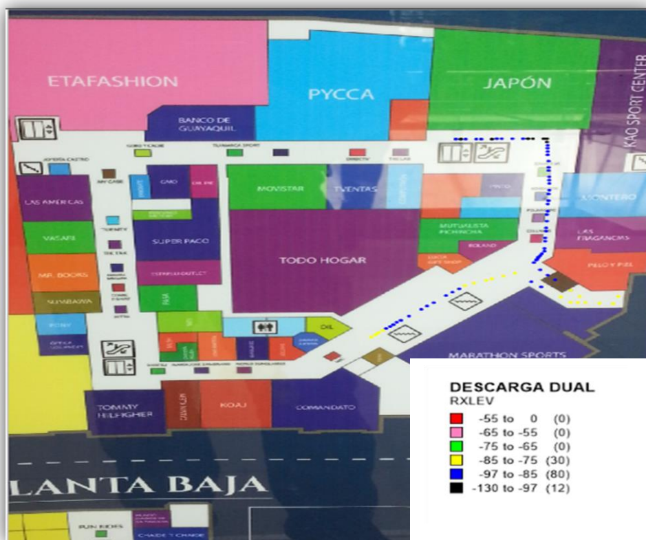
Figura 30 Walk test del Piso 1 del centro comercial, descarga dual RXLEV
