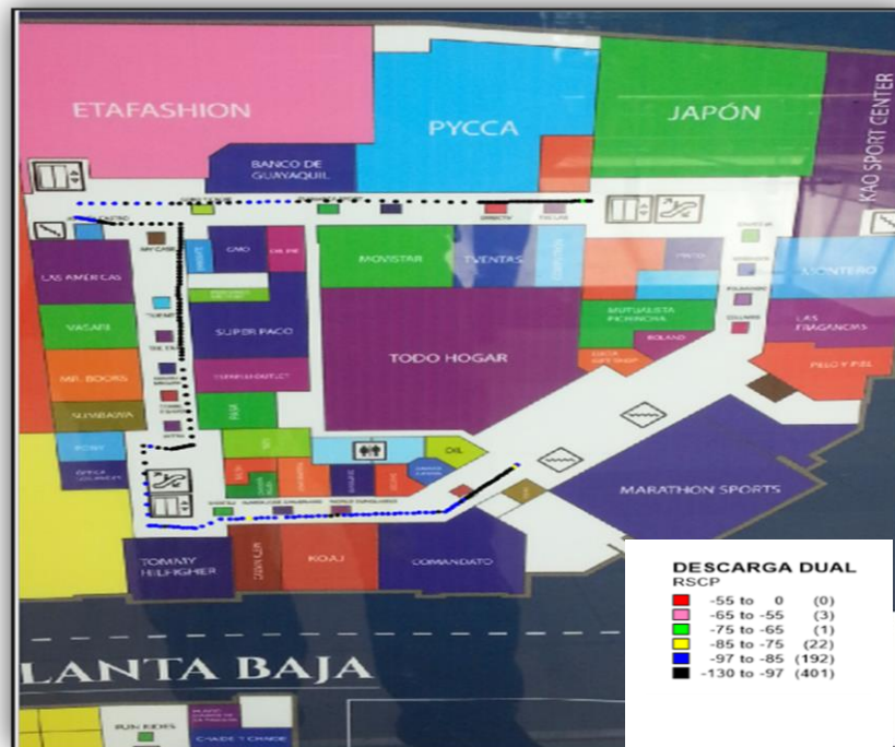
Figura 31 Walk test del Piso 1 del centro comercial descarga dual RSCP
