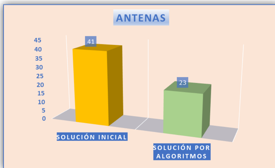
Figura 43 Comparación del número de antenas en las soluciones de cobertura celular en el centro comercial.
