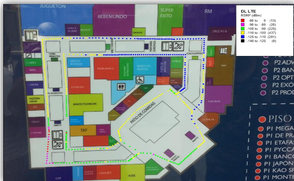
Figura 34 Walk test del Piso 2 DL LTE RSRP.
