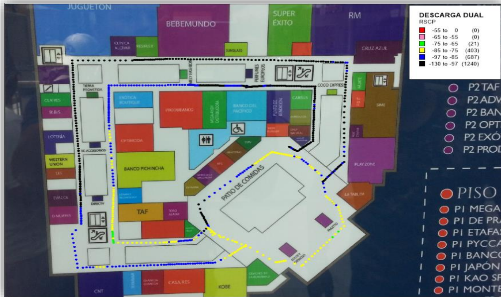
Figura 33 Walk test del Piso 2 del centro comercial RSCP.
