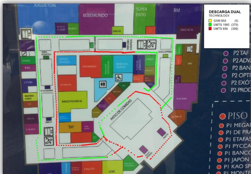
Figura 32 Walk test del Piso 2 del centro comercial por tecnología.
