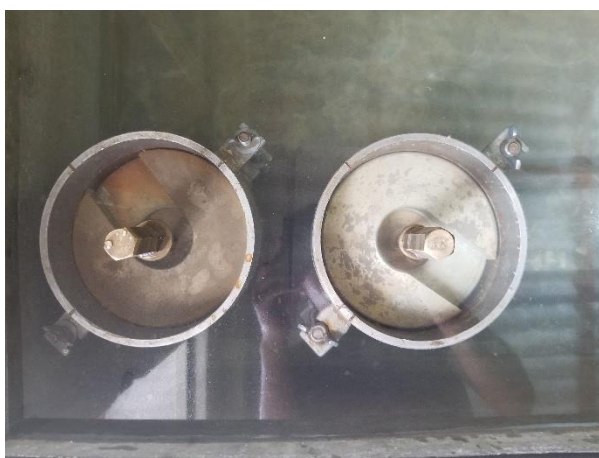
Figura 3.15 Cilindros con material granular para ensayo CBR. Fuente: Mejía, M., Muñoz, H., 2018.
