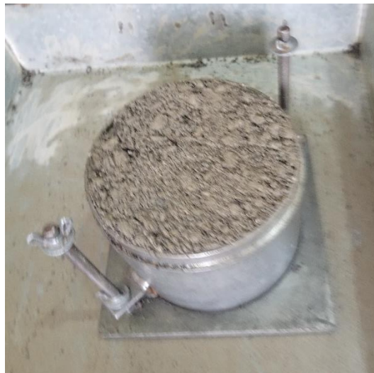
Figura 3.14 Cilindro con material granular para ensayo Proctor Modificado.
