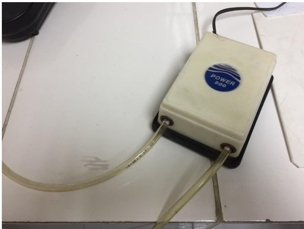
Figura 3. 3 Aireador usado en las pruebas de adición de oxígeno disuelto
