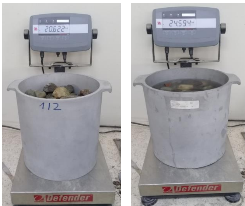
Figura 3. 37 Peso de recipiente con muestra SSS. Peso de recipiente con muestra SSS + Agua.
