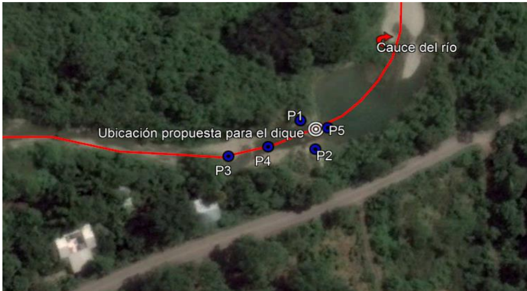
Figura 3. 15 Ubicación de los puntos donde se realizó la toma de muestras para ensayos. Fuente: Google Earth.
