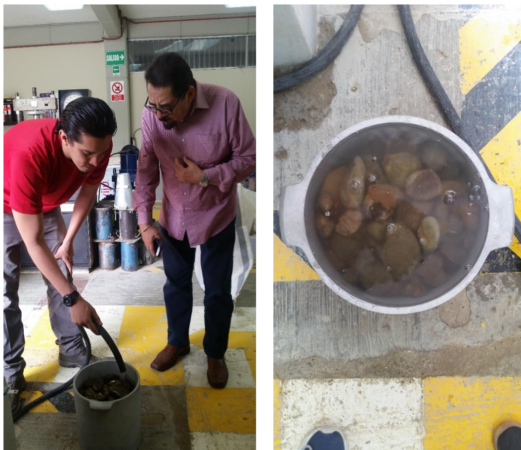
Figura 3. 36 Recipiente con la muestra mientras es llenado de agua para ponerla a saturar.
