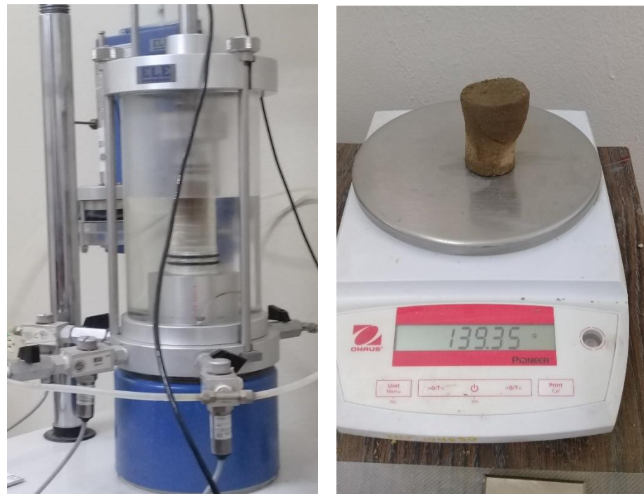
Figura 2. 11 Probeta cilíndrica en cámara de confinamiento. Tipo de falla de la probeta.
