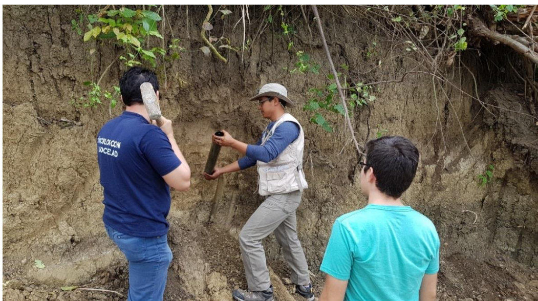
Figura 3. 18 Hincada de tubo Shelby en talud.
