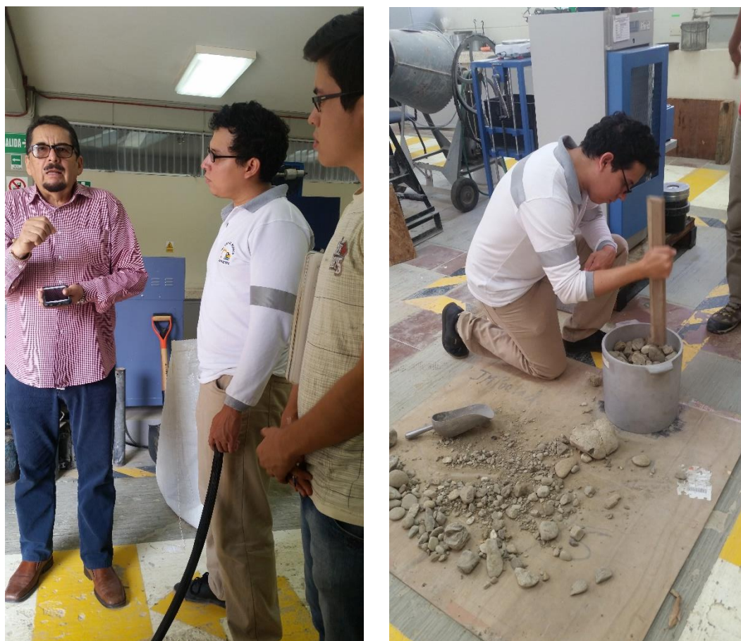
Figura 3. 35 Instrucciones del Ph.D. Miguel Ángel Chávez para la realización del presente ensayo. Compactación de la muestra por capas en el recipiente.
