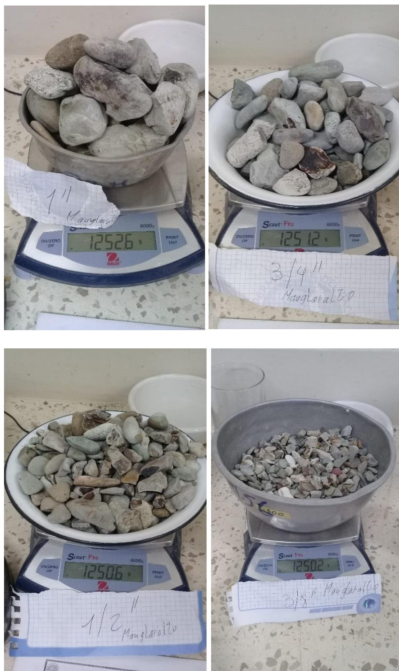
Figura 3. 40 Peso de muestras secas, para ingresar en máquina de abrasión de Los Ángeles.
