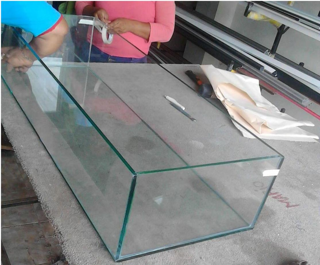
**Figura D-2.** Pegado final de las paredes del tanque.
