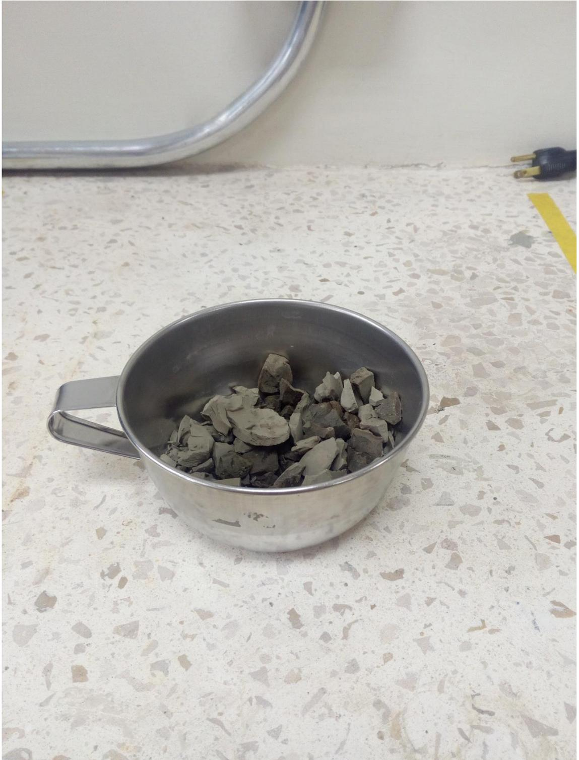
**Figura B-15.** Mortero utilizado para pulverizar el lodo seco.
