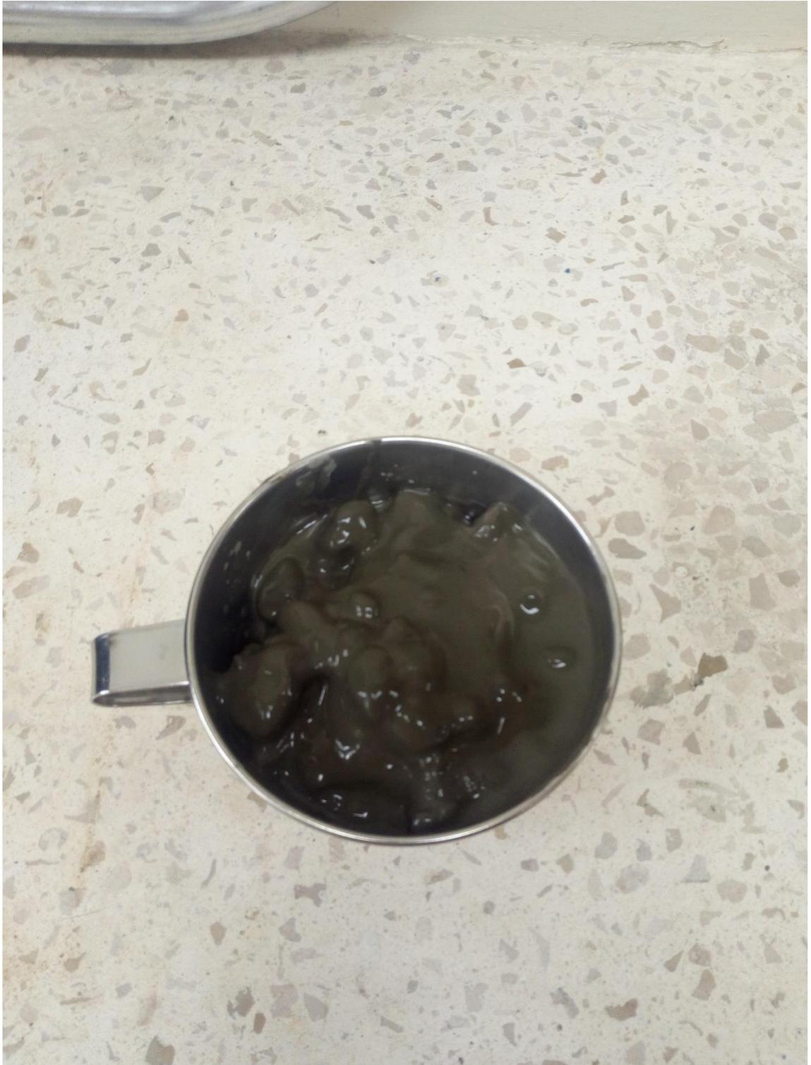
**Figura B-14.** Lodo seco listo para pulverizarlo.
