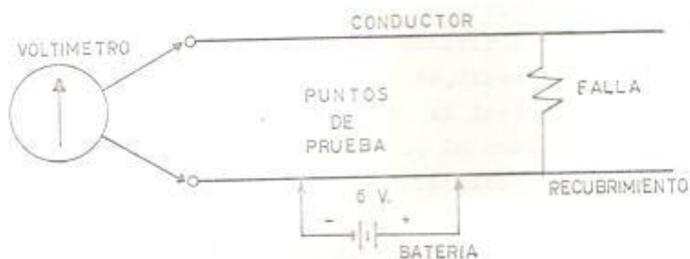
DIFERENCIA DE POTENCIAL DC SOBRE EL RECUBRIMIENTO
