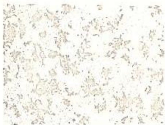
Microfotografía Nr. 29 100 X nódulos de grafito uniformemente distribuidos (micro- fotografía tomada a dos centímetros del borde)
