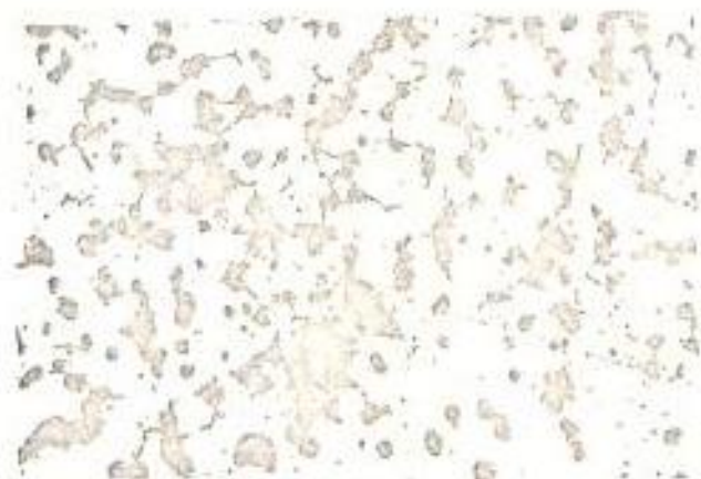
Microfotografía Nr. 28 100 X sin ataque exceso de carbono for- ma grandes aglomera- ciones de grafito
