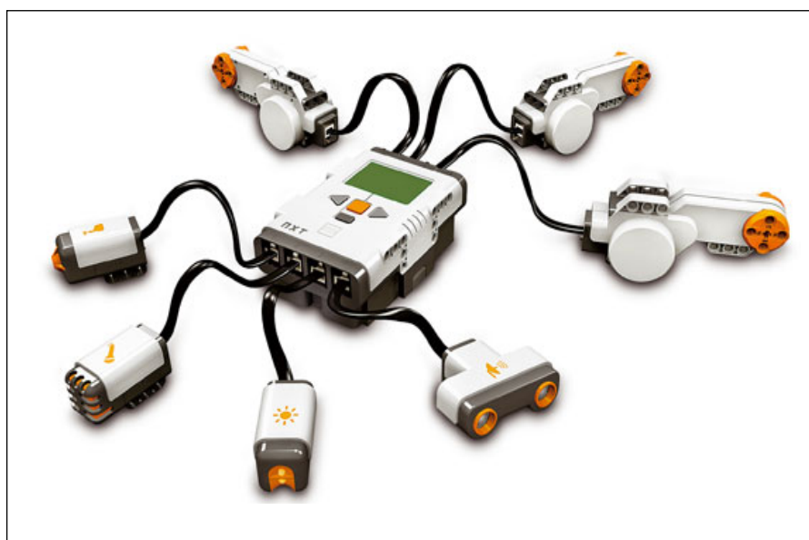
Figura 2.1: Imagen del LEGO Brick y sus componentes
