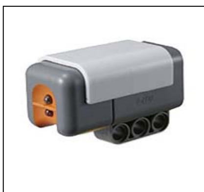
Figura 2.5: Sensor de Luz LEGO Mindstorm
