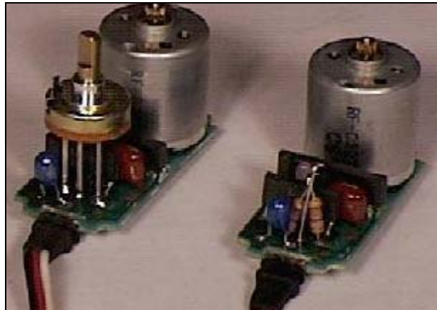
Figura 2.13: Circuito de control del servomotor
