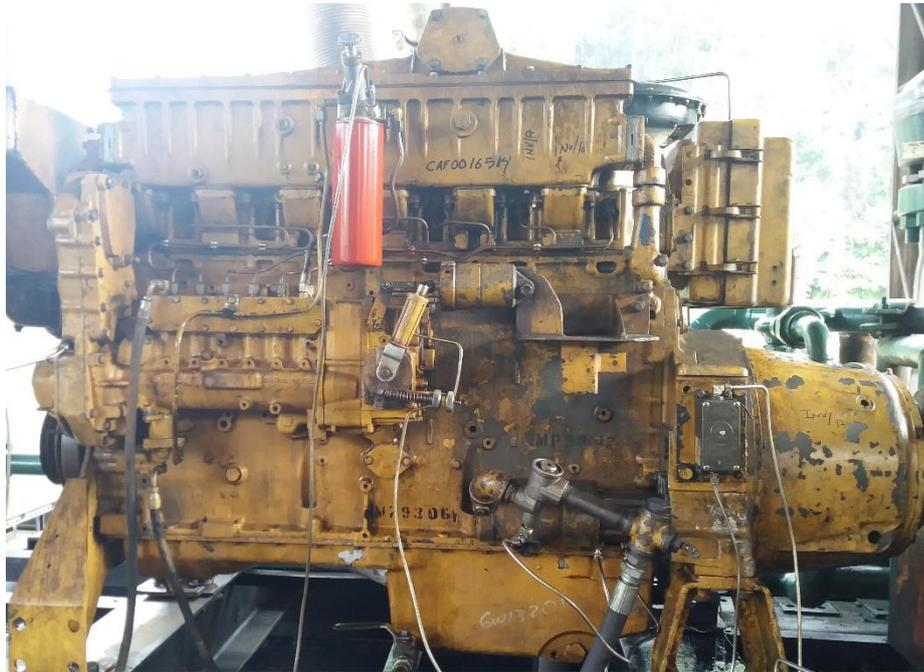
**Figura 1.19 motor de bomba quintuplex**
