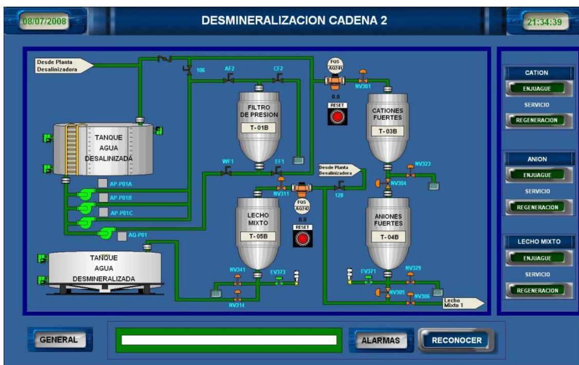
Figura 2.1 Esquemático, proceso de agua desmineralizada.
