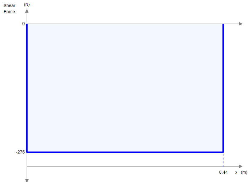
Figura 3. 24. Diagrama cortante del marco estructural de zona de empaquetado. Fuente: Software libre
