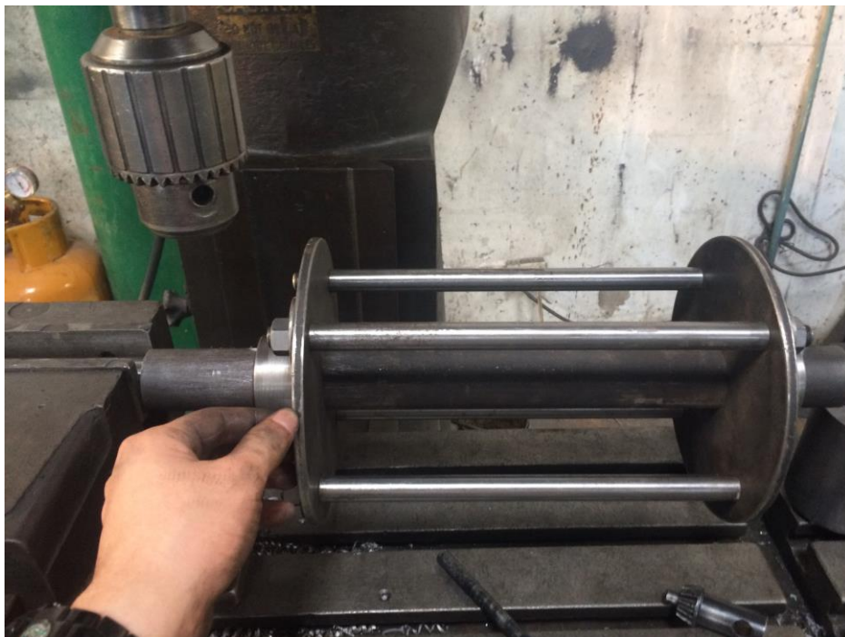
Fotografía P. 6 Calibración de espárragos, platos laterales y eje.
