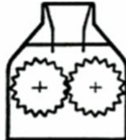
Figura 1.6 Trituradora de rodillo. [Duda, 1977]
