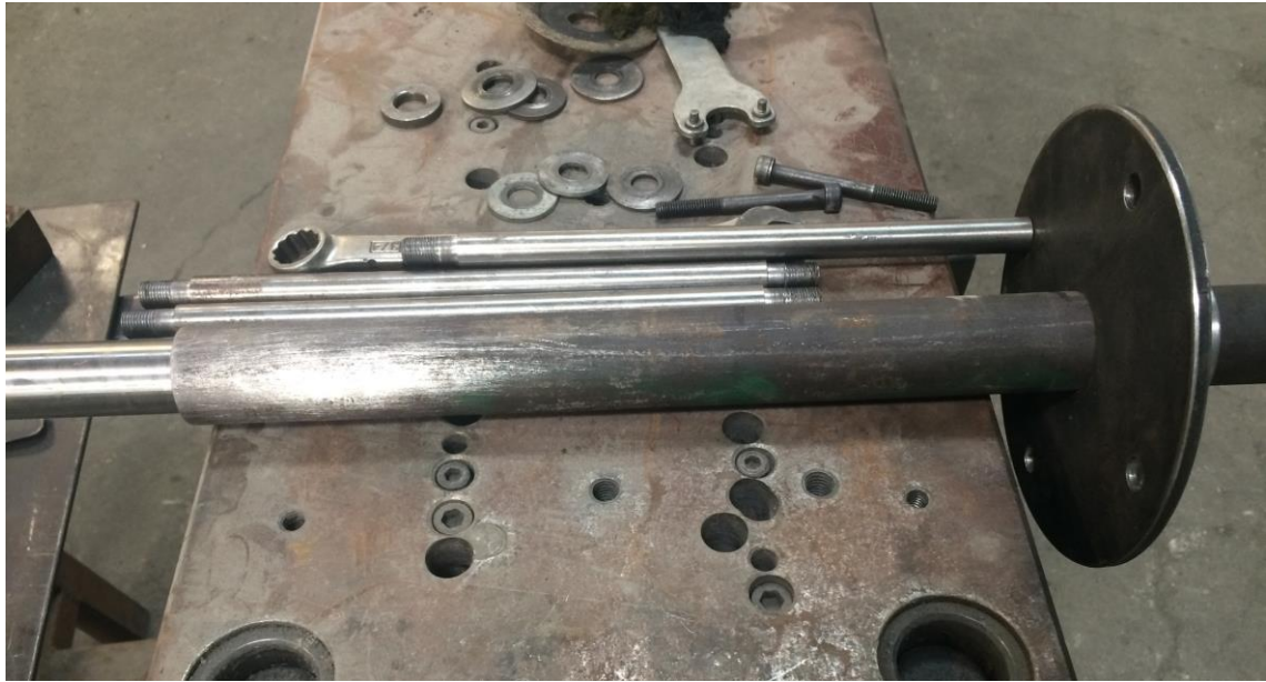
Fotografía P. 5 Construcción de eje de transmisión.
