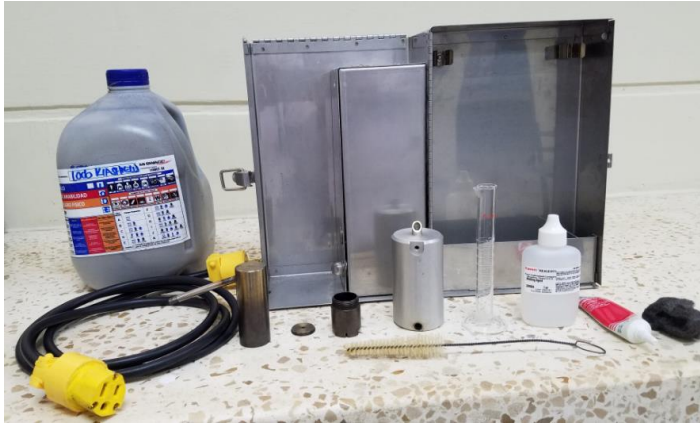
Figura 4.6. Kit retorta con lodo de perforación MI SWACO Fuente: Ruiz, R., Mendoza, B., 2018
