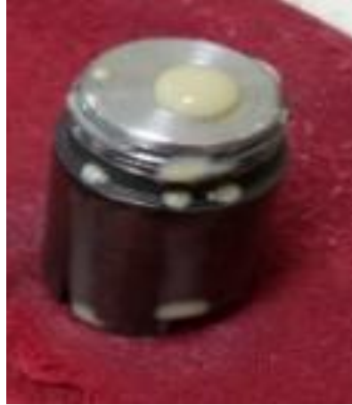
Figura 3.10 Cámara de lodo llena Fuente: Ruiz, R., Mendoza, B., 2018
