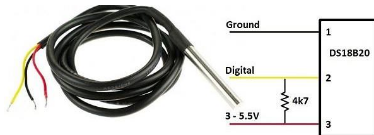
Figura 2.18 Conexión de la Sonda de Temperatura DS18B20
