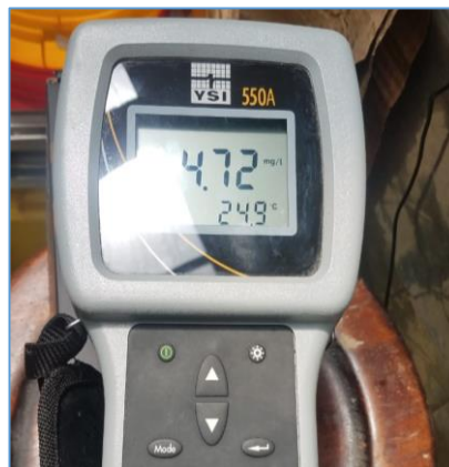
Figura 3.2 Medición de Oxígeno y Temperatura con YSI 550A
