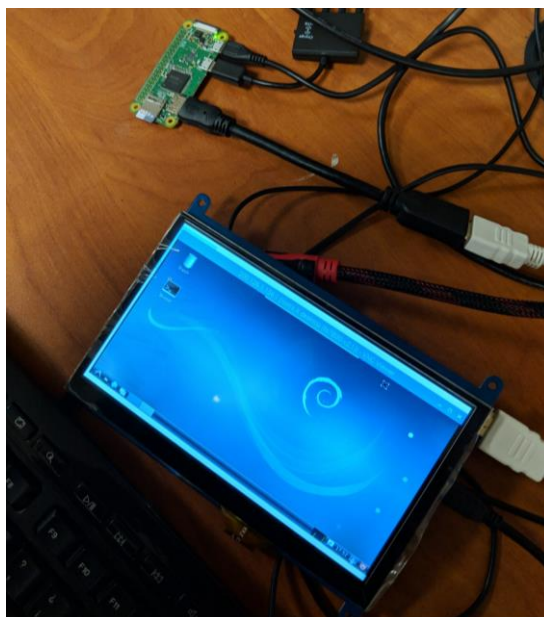
Figura 2.1.4. Pantalla táctil junto con Raspberry Pi Zero W. Autoría propia.
